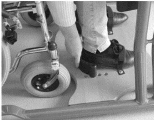
Abbildung 5: Einstellung der Fersenschalen und Zehenfixierung
