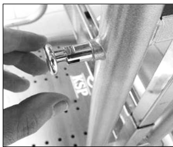
d. Lasciare l'elemento in modo che rimanga in posizione estratta e ripetere l'operazione per entrambi i dispositivi di blocco
