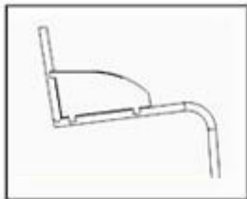
ΠΛΑΪΝΟ ΑΛΟΥΜΙΝΙΟΥ ΣΥΓΚΟΛΛΗΜΕΝΟ ΣΤΟ ΣΚΕΛΕΤΟ ΜΕ ΠΡΟΣΤΑΤΕΥΤΙΚΟ
